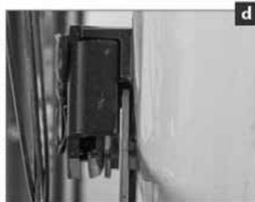
Wenn Sie mehrfach nachstellen, ändert sich die Stellung des Hebels am Bremssattel. Die Wirkung der Bremse wird schwächer. Im Extremfall kann die Bremse komplett ausfallen. Unfallgefahr!
