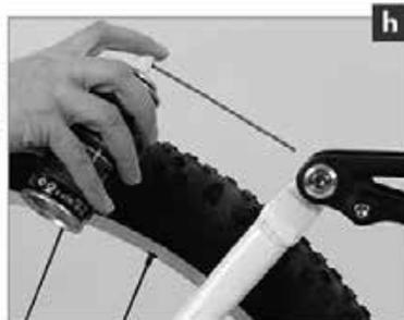
Federn Sie den Hinterbau dann mehrfach ein (a) und wischen Sie die Schmiermittelreste vor der nächsten Fahrt mit einem sauberen Lappen ab.
