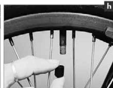
**Autoventile** und – mit speziellem Adapteraufsatz – auch **Presta-ventile** können Sie an der Tankstelle mit dem Pressluft-Spender füllen. Betätigen Sie den Luftspender in kurzen Stößen, da sonst zu viel Luft in Ihren Reifen gelangen und dieser platzen könnte. Um Luft abzulassen, drücken Sie beim Autoventil den Stift in der Mitte (a), beim Presta-ventil die gerändelte Mutter kurz hinein (b).
