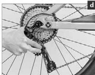
Durch diese Einstellung verhindern Sie, dass die Kette zwischen Ritzel und Speichen gerät oder das Schaltwerk bzw. sein Leitrollenkäfig die Speichen berühren kann – dadurch könnten Speichen, Schaltwerk und Rahmen beschädigt werden. Schlimmstenfalls ist eine Weiterfahrt nicht mehr möglich.
